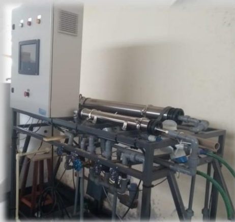
Sistema de separação por membranas de micro, ultra, nano, osmose e inversa.
